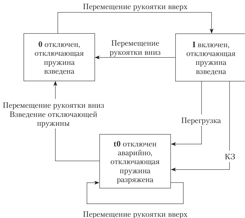
Рис. 2.5. Диаграмма состояний и переходов автоматического выключателя
